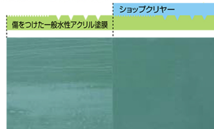
上図は一般水性アクリル塗料をした面をサンドペーパー及びコインで傷をつけ、その上にショップクリヤーを塗装した状態を表しています。
