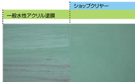
上図は一般水性アクリル塗料の上にショップクリヤーを塗装してタイヤ片及びコインで擦りつけたときの汚染及び擦り傷の状態を表しています。
