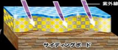
クリスタルロックシリーズにより塗膜表面で紫外線の透過を防ぎサイディング表面の塗装の劣化を防止します。また強靭な塗膜硬化により長期間、耐久性を発揮します。
